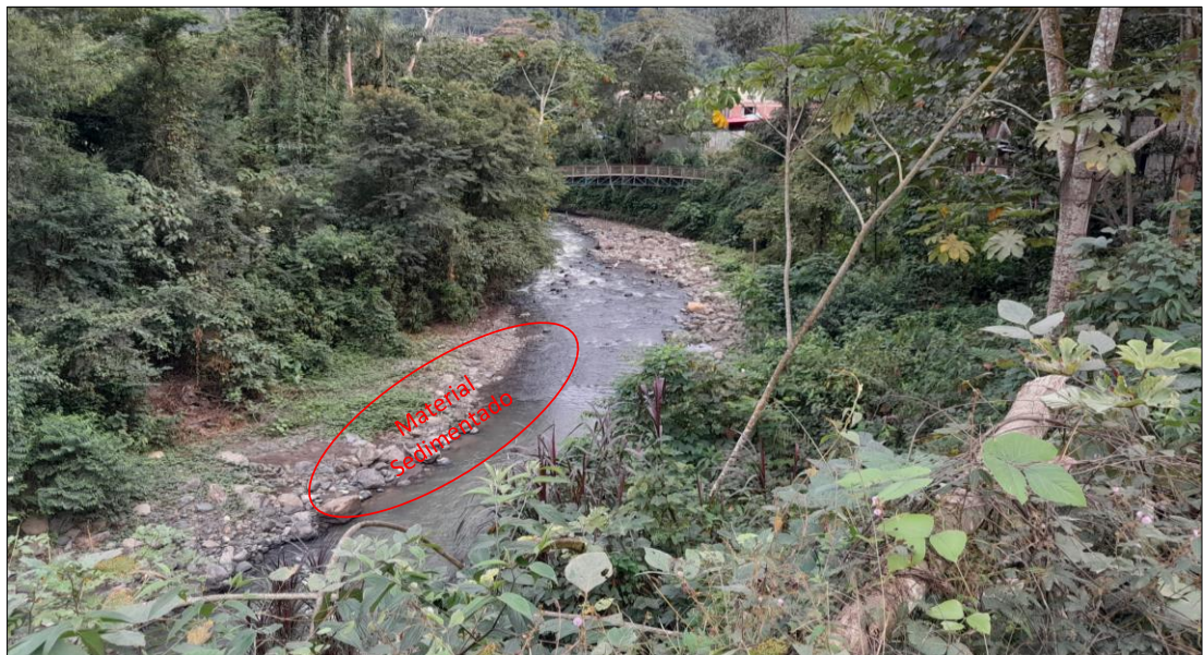
FIGURA N°02: MATERIAL COLMATADO EN EL CAUCE DEL RÍO IVOCHOTE, CON UNA PROFUNDIDAD PROMEDIO DE 1.0 M. ESTO PROVOCA QUE DESBORDAMIENTO DEL RÍO SEA MAS INMINENTE.
